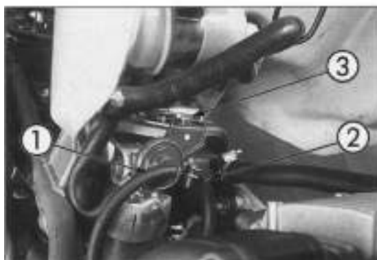
Bild 8 Unterdruck-Benzinhahn 1 Unterdruckschlauch 2 Benzinschlauch zum Vergaser 3 Befestigungsschraube
