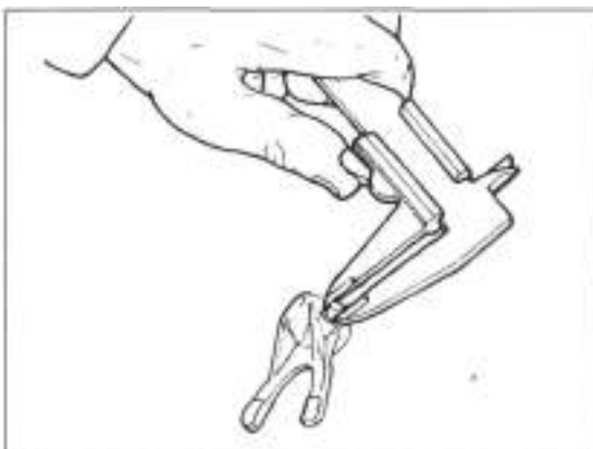
Bild 202 Breite der Schaltwalzennut messen
