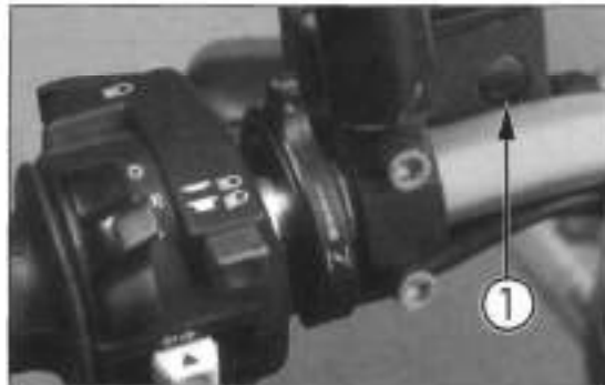
Bild 14 Chokeyhebel bei neuer Ausführung am linken Lenkerende 1 Kupplungshydraulikpegel-Kontrollfenster
