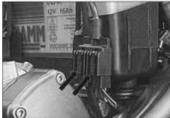
Bild 41 Pluskabel trennen: Halteblechen eindrücken
