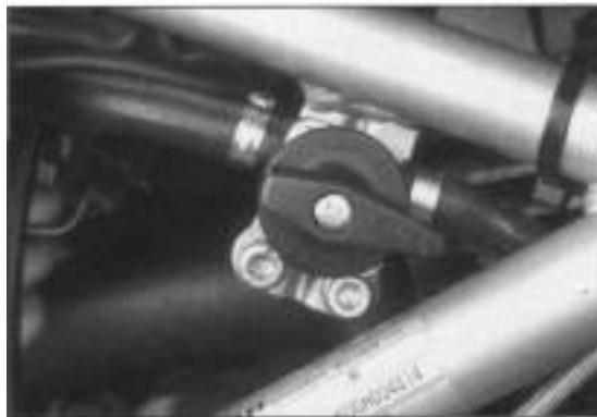
Bild 6 Manueller Benzinhahn rechts in Fahrzeugmitte
