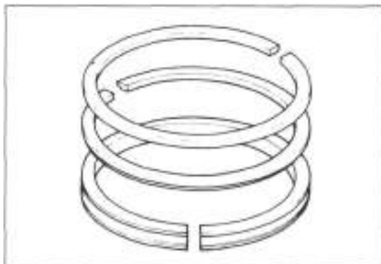
Bild 175 M 600/750: Einbaulage der Kolbenringe
