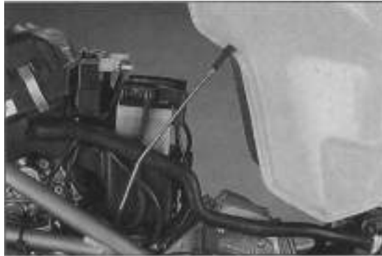
Bild 5 Tank aufklappen und mit Stütze sichern
