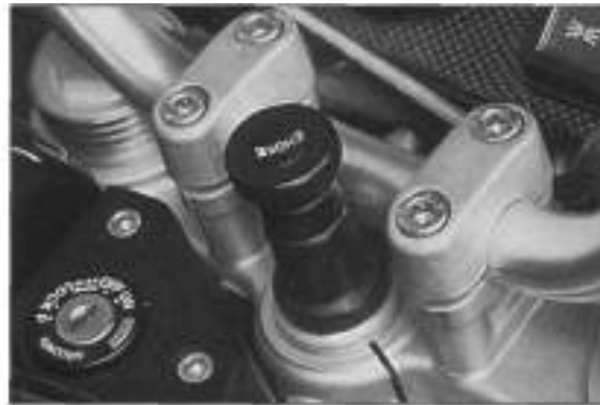
Bild 12 Rechte Lenkerhälfte 1 Staubkappen der Gasschieber-Spieleinsteller 2 Bremsflüssigkeitspegel-Kontrollfenster 3 Deckelschrauben des Bremsflüssigkeitsbehälters
