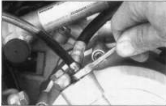
Bild 43 M 600/750: Kupplungshydraulik entlüften
