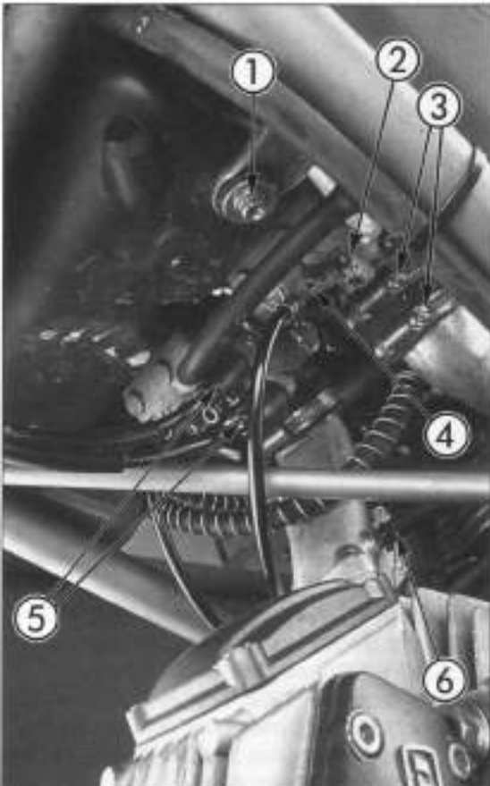
Bild 11 Vergaser 1 Luftfiltergehäuse- Befestigungsschraube (2 x) 2 Schwimmerkammer- Ablassschraube 3 Schlauchschellen 4 Schwimmerkammer- Ablassstutzen 5 Seilzug-Staubkappen 6 Unterdruckschlauch zum Benzinhahn
