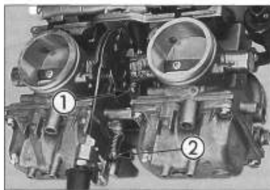
Bild 16 Vergaser einstellen 1 Abgleichschraube 2 Leerlauf-Einstellschraube
