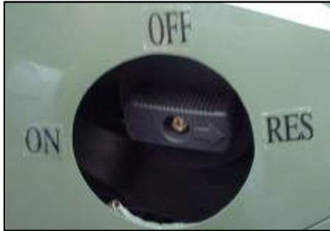
Der Kraftstoffhahn befindet sich auf der linken Seite des Fahrzeuges.
