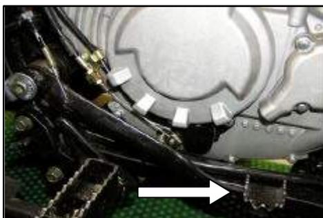
Mit dem Fußbremspedal werden **Vorder- und Hinterradbremse** betätigt.
