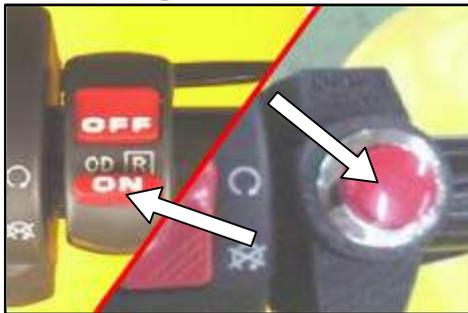
Bei einigen Modellen ist eine Übersteuerfunktion des Drehzahlbegrenzers zum Schutz des Getriebes bei Rückwärtsfahrt verbaut.
