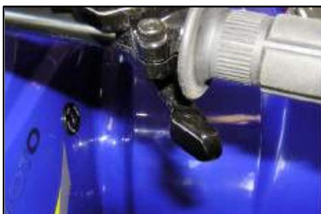
Kontrollieren Sie den Gaszug durch Drehen des Gashebels von Leerlauf bis Vollgas auf Leichtgängigkeit. Durch Bewegen des Lenkers kontrollieren, dass der Gaszug nicht schueert. Prüfen Sie, ob der Gaszug von anderen Teilen in seiner Funktion behindert wird.
