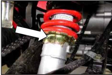
Einstellring mit einem speziellen Hakenschlüssel nach rechts (= härtere Federung) oder nach links (=weichere Federung) drehen.
