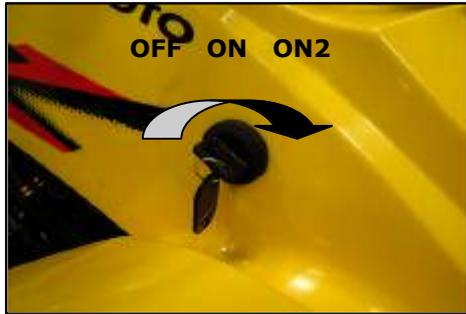
Das Zündschloss dient in Position „ON“ zum Starten des Motors. In der Position „ON2“ sind zusätzlich Scheinwerfer und Rücklicht eingeschaltet.
