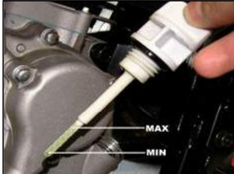
Ölkontrollschraube am unteren Ende mit einem sauberen und fusselreien Tuch reinigen.
