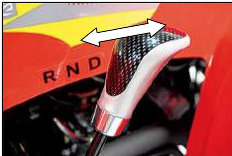
**ACHTUNG:** Schalthebel nur bei Stillstand der Räder und Standgasdrehzahl sowie **voll betätigter Fußbremse** betätigen. Getriebeschäden könnten die Folge sein.
