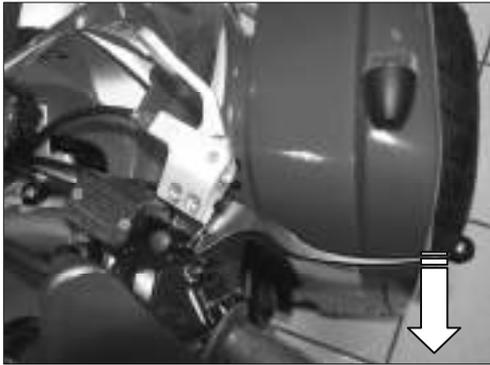
Durch Ziehen des rechten Handbremshebels wird die Vorderradbremse betätigt.
