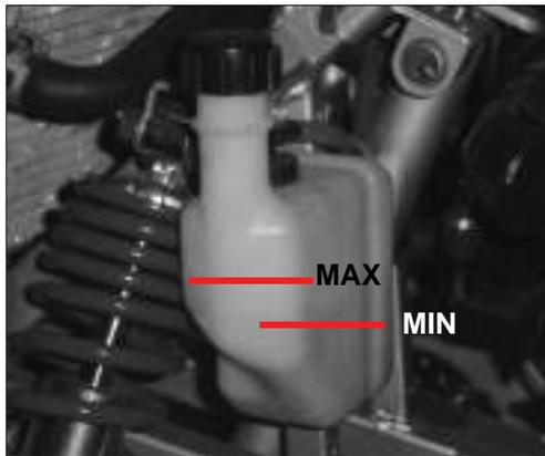
Stellen Sie das Fahrzeug auf ebenen Untergrund und überprüfen Sie den Füllstand der Kühlflüssigkeit. Der Pegel sollte im kalten Zustand zwischen der MIN und MAX Markierung stehen.
