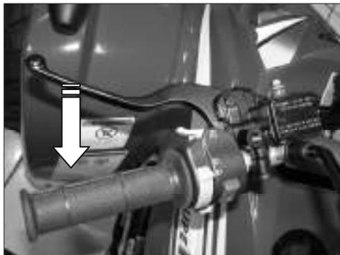
Durch Ziehen des linken Handbremshebels wird die Hinterradbremse betätigt.
