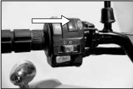
Die Anlage funktioniert bei eingeschalteter Zündung. Bei eingeschalteter Warnlichtanlage blinken alle vier Blinkleuchten gleichzeitig.
