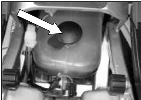
Kontrollieren Sie vor jeder Fahrt den Motorölstand. Der Öltank befindet sich unter der Sitzbank. Der Tank hat eine Kapazität von 0,8l.
