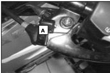
Prüfen Sie den Bremshebel der Feststellbremse auf korrekte Funktion.
