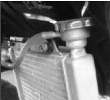
Der Radiator ist unter der vorderen Frontverkleidung montiert. Prüfen Sie NUR bei kaltem Motor.
