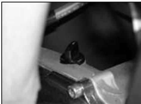
Der Getriebeöltank befindet sich mittig auf dem Getriebe. Hier ist auch der Kontroll- und Einfüllstutzen. Prüfen Sie den Getriebeölstand regelmäßig. Drehen Sie hierzu den Kontrollstopfen heraus, wischen Sie ihn ab und stecken Sie ihn wieder auf. Beim erneuten Herausziehen sollte der kleine Peilstab zum Teil mit Öl bedeckt sein. Ist dies nicht der Fall, muss entsprechend Getriebeöl nachgefüllt werden.
