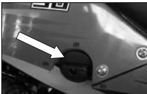
Der Kraftstoffhahn befindet sich auf der linken Seite des Fahrzeuges.
