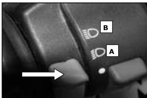
(A) In dieser Position ist bei eingeschalteter Zündung das Ablendlicht und das Rücklicht eingeschaltet.
