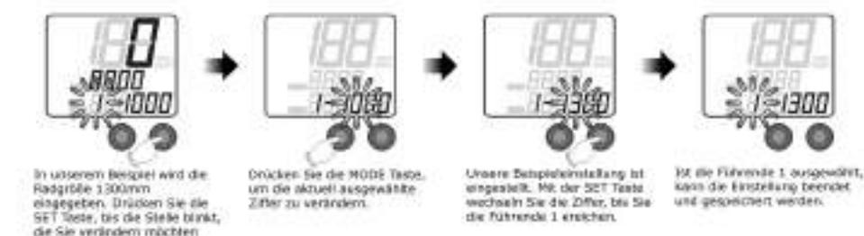
**⚠** Eingestellt werden kann ein Radumfang von 0-2999mm. Messen Sie den Umfang vor dem Einstellen genau, um fehlerhafte Anzeigen zu vermeiden.
