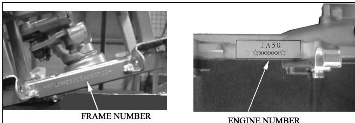
Zur Fahrzeugidentifikation sind an der rechten Seite des Rahmens die Fahrgestell-Nummer (Frame Number) und an der Motorgrundplatte die Motornummer (Engine Number) angebracht. Geben Sie bei allen Nachfragen oder Bestellungen diese Nummern an, um Fehlinformationen oder Falschlieferungen zu vermeiden.
