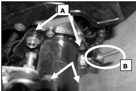
Zur Einstellung Schrauben (A) (2 auf jeder Seite) lösen und mit der Schraube (B) die Kette spannen.
