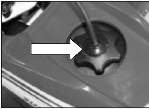
Der Tankdeckel (A) wird entgegen dem Uhrzeigersinn geöffnet
