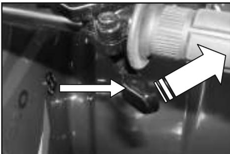
Der Gashebel dient zur Beschleunigung der Motordrehzahl. Wird der Gashebel losgelassen, geht dieser automatisch nach links in seine Ausgangsstellung zurück.
