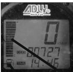
Die Kraftstoffanzeige befindet sich auf der linken Seite der Konsole. Ist der Tank voll, werden 15 Balken angezeigt. Der Kraftstoffverbrauch wird mit sinkenden Balken angezeigt.
