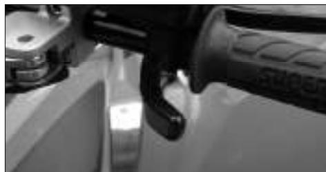
Kontrollieren Sie den Gaszug durch Drehen des Gashebels von Leerlauf bis Vollgas auf Leichtgängigkeit. Durch Bewegen des Lenkers kontrollieren, dass der Gaszug nicht scheuert.
