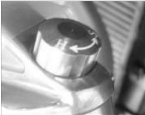
Das Drehen des Einstellknopfes auf dem Ausgleichsbehälter in Richtung (S) macht die Fahrwerkeinstellung weicher. Das Drehen in Richtung (H) macht die Fahrwerkeinstellung härter.
