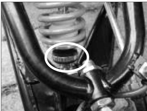
Die Einstellung des Stoßdämpfers beeinflusst den Abbau der gespeicherten Energie der Fahrwerksfeder.
