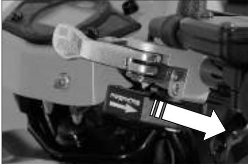
Betätigen Sie die Kupplung mit dem Kupplungshebel und halten Sie diesen.
