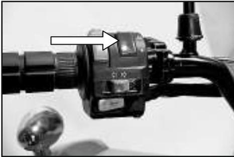
Die Anlage funktioniert bei ausgeschalteter Zündung. Bei eingeschalteter Warnlichtanlage blinken alle vier Blinkleuchten gleichzeitig.
